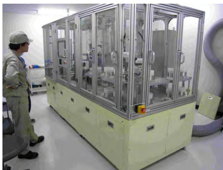
写真2 「粉詰め自動機」外観（操作盤面側）
