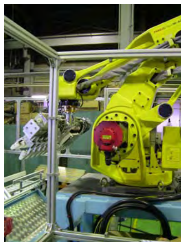
図 3-2 作業場への侵入部(2) ステップから作業部へ侵入する 開口部。
