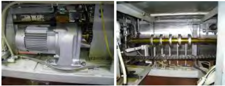
図 12. 駆動機構に関連する危険源
