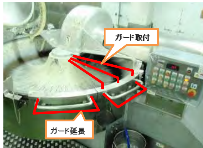
図 12. 最終的に決定された防護方策
