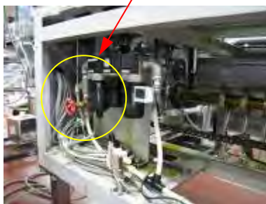
図 11. 駆動エア残圧に関連する危険源
