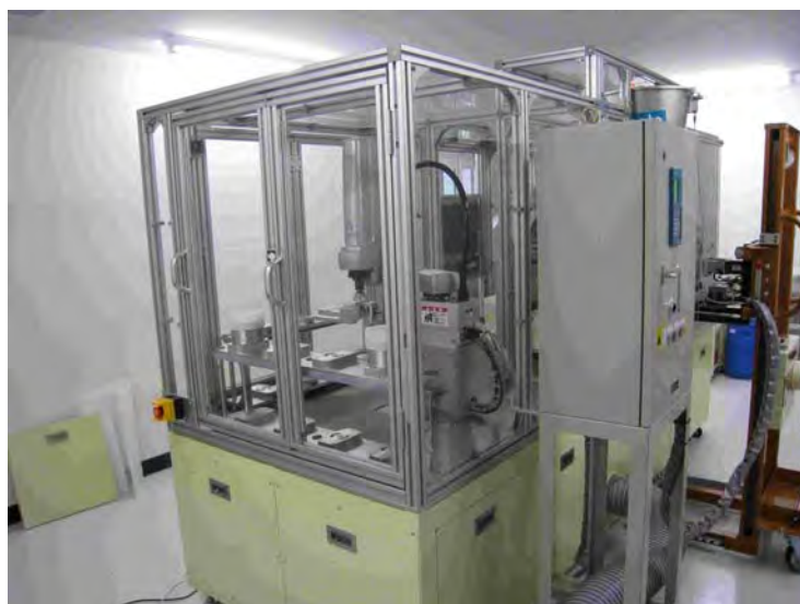
写真1 「粉詰め自動機」外観（粉供給部側）
