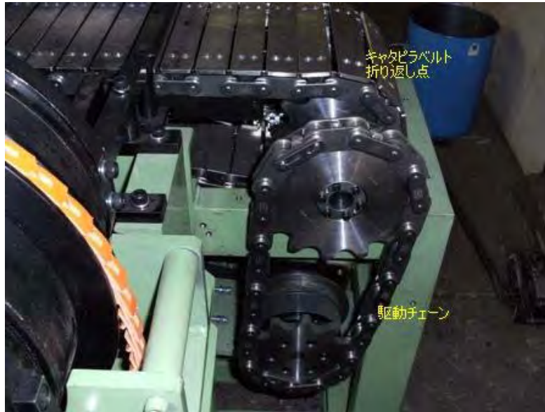
写真5 キャタピラベルトコンベア駆動部
