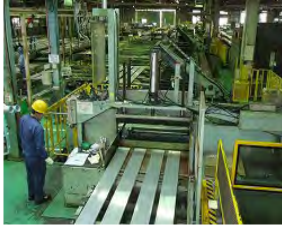
⑥ 後面設備（製品切断機-2）
