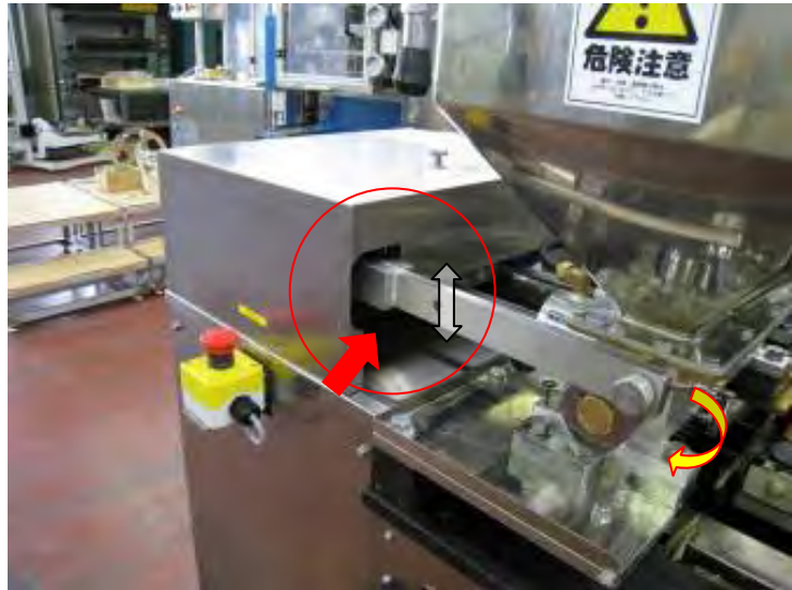
図 16. 可動ガードの危険源
