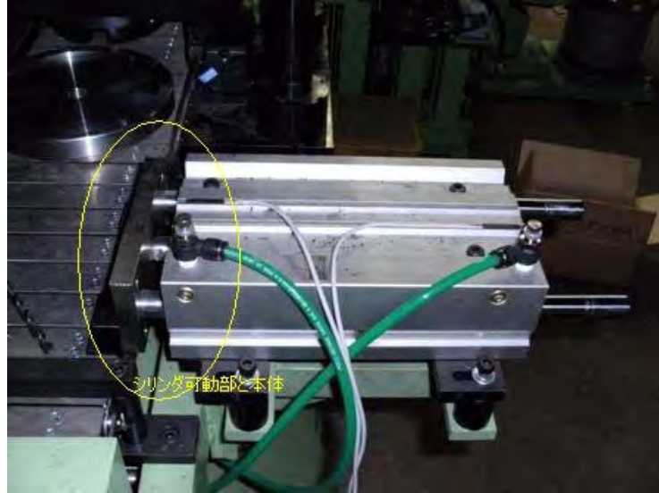
写真 3 金型押出機構
