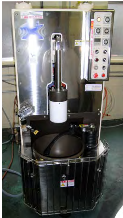
写真1 D社クランク式自動餅搗機
